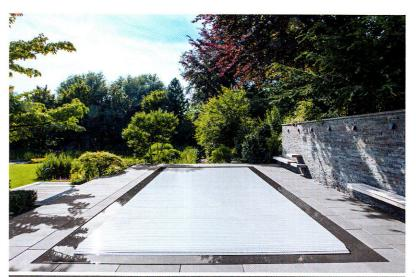
Die Unterflur-Rollladenabdeckung schützt das Wasser im Becken vor dem Laub der Bäume und hält zudem die Wärme im Pool.
